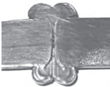
Figura 10. Imperfecțiune artificială de tip plan, simulată prin tehnica tăierii LASER a unei îmbinări sudate cap la cap cu element încălzitor dintre două țevi din PEHD
