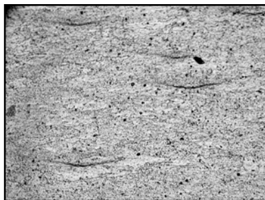
Figura 3. Lipsa de aderență între straturi în zona de retragere; x100/
